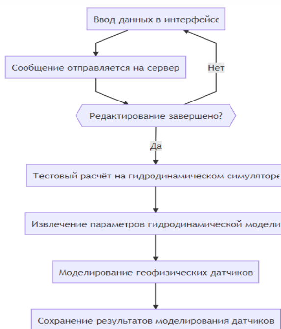
Рис. 1.4.6.1. Схема программного модуля геофизических данных
