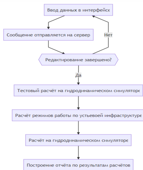
Рис. 1.1.6.1. Схема программного модуля устьевой инфраструктуры
